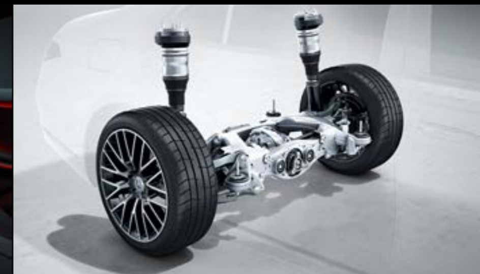
201 – Hinterachslenkung mit 3° Lenkwinkelverstellung
