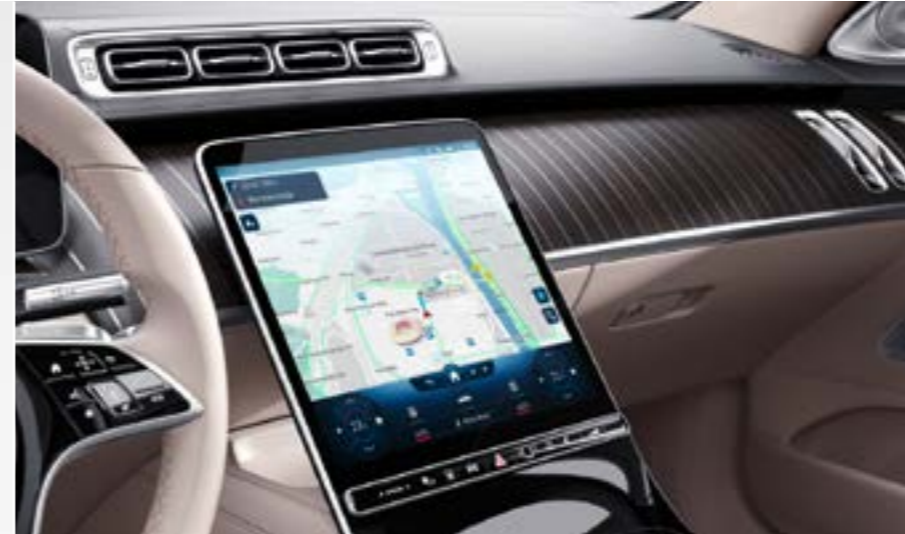
868 - 12,8" OLED Zentralsdisplay mit MBUX Augmented Reality für die Navigation
