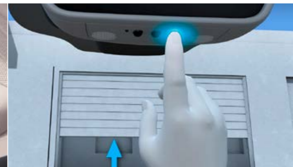
231 – Commande ouverture porte de garage
