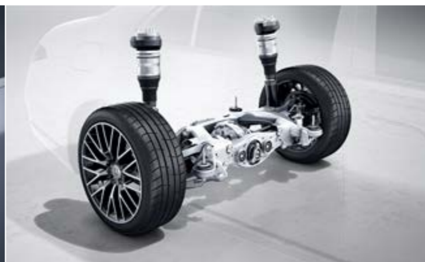
201 – Roues arrière directrices avec adaptation de l'angle de braquage de 4,5°
