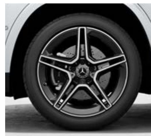
RTG - Cerchi in lega leggera AMG da 48,3 cm (19") a 5 doppie razze A richiesta (CHF 0.-) 2
