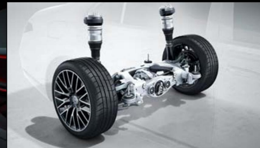
201 – Sterzo sull'asse posteriore con regolazione dell'angolo di sterzata di 3°
