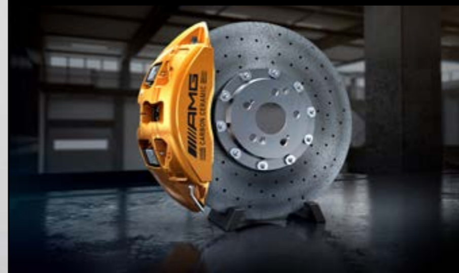
Système de freinage AMG en céramique composite haute performance (B07)
